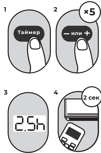
Пример: установка таймера на включение блока через 2,5 часа.
